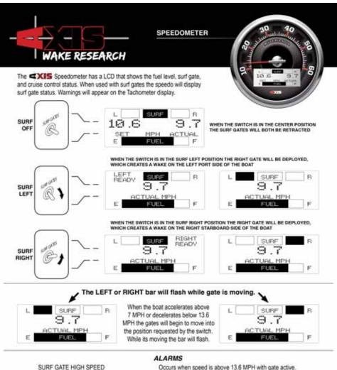
SURF GATE HIGH SPEED SURF GATE LOW SPEED SURF GATE GENERAL ERROR SURF GATE RETRACT LEFT OR RIGHT SURF GATE EXTEND LEFT OR RIGHT
